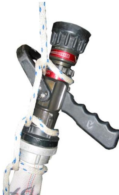
Eine Löschleitung wird zum Aufziehen vorbereitet in dem die Leine mit einem Kreuzklink über beide Kupplungshälften und mit einem ganzen Schlag am vorderen Ende des Strahlrohres befestigt wird.
